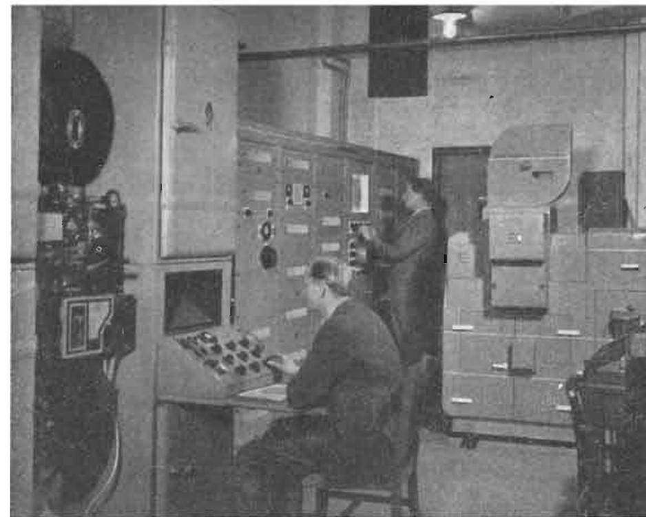
Apparecchiatura B.B. C. per la trasmissione delle pellicole cinematografiche.
